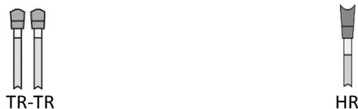
Der Zahneingriff erfolgt ebenfalls auf der Dekorseite der Platte. Beidseitig gute Kanten werden nur unter Einsatz eines passenden Vorritzers erreicht.
